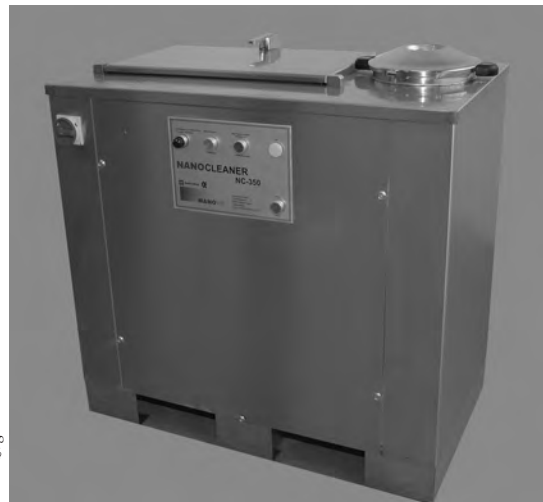
Der Nanocleaner der Firma Nanovis reinigt die Werkzeuge des Tampondrucks ohne viel Aufwand.
